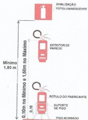
Cada extintor será sinalizado individualmente com numeração sequencial gravada no casco e na placa de PVC. A numeração, tipo, carga, capacidade extintora e localização dos extintores previstos para o prédio em questão estão descritos na tabela que segue:
